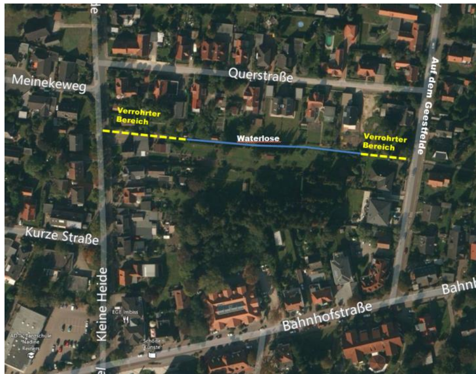
Abb. 22 Waterlose mit verrohrten und offenen Bereichen
