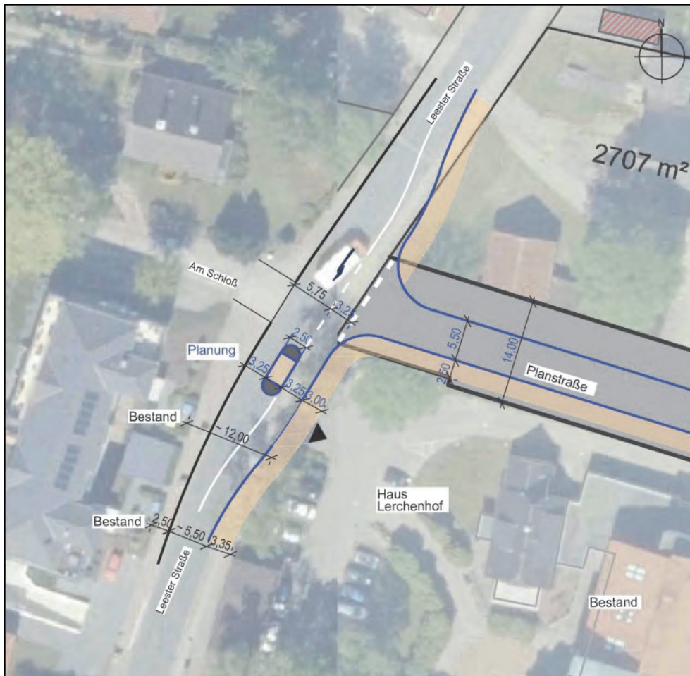
Abb. 6.5: Querungs- und Linksabbiegehilfe in der Leester Straße
