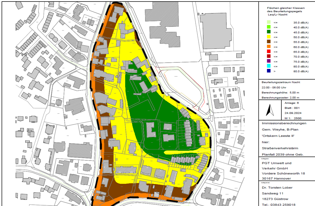
Abbildung 6: Flächen gleicher Klassen des Beurteilungspegel in der Nacht. Quelle: PGT-Umwelt und Verkehr GmbH (2024)
